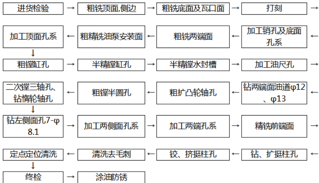
图 2-2 缸体生产工艺流程图
