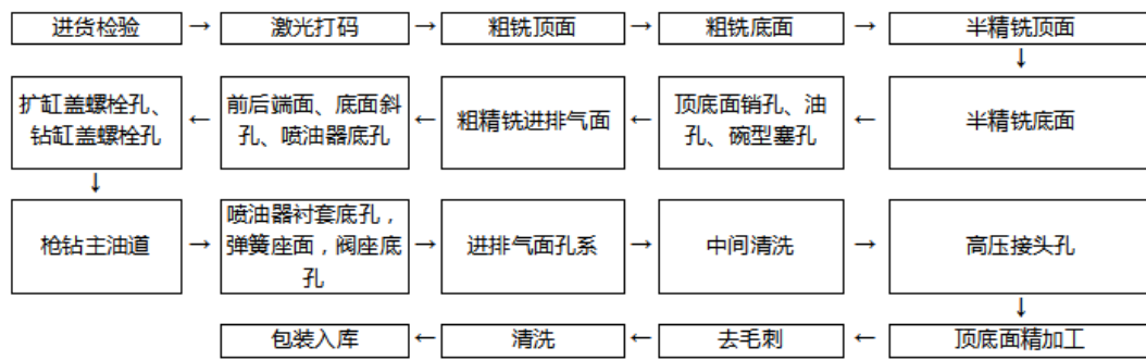
图 2-1 缸盖生产工艺流程图
