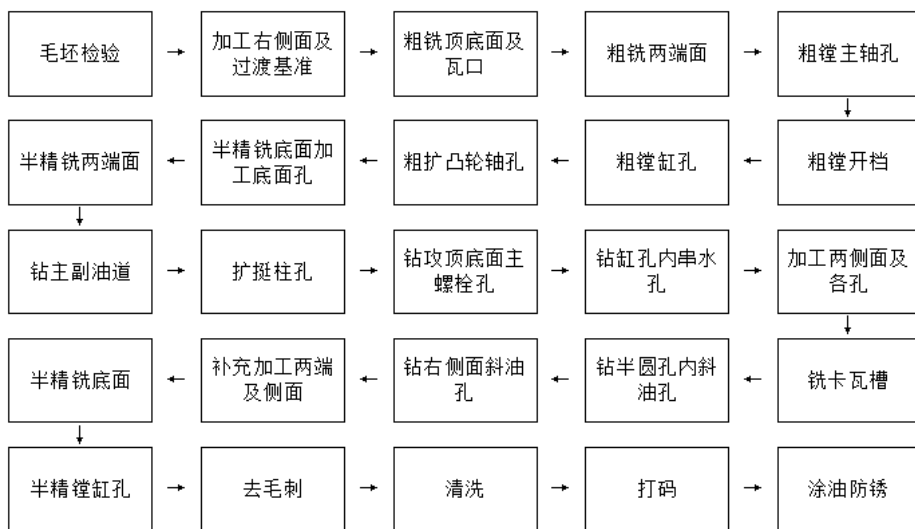
图 2-4 缸体生产工艺流程图
